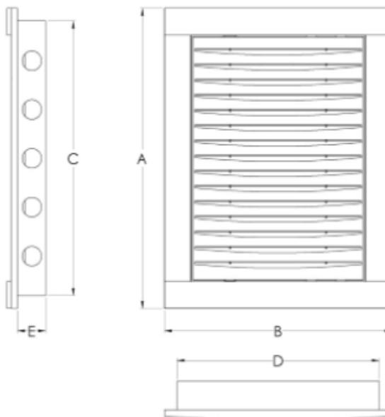
**Descrição do produto :** Grelhas de Ventilação em plástico ABS para aplicação em ventilações. Com filtro híbrido para ventilação natural de locais com elevada humidade. Aplicável em paredes ou tectos, fixando com parafusos. Em plástico branco .
